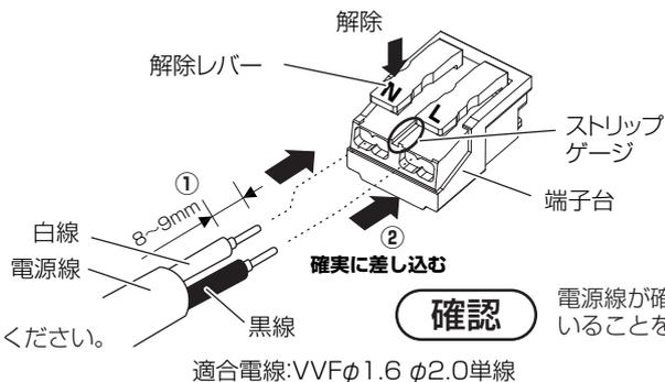
電源線が確実に接続されていることを確認してください。
