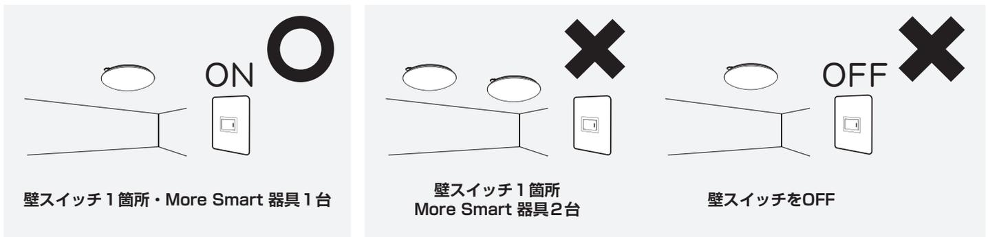
壁スイッチが1つの場所に複数台の More Smart 器具を設置すると、器具が正常に動作しない恐れがあります。
