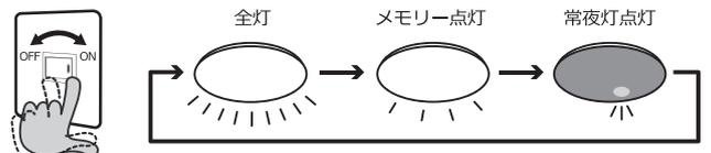
壁スイッチを素早く(約3秒以内に) OFF ⇄ ON を切り替えると上図のように点灯状態が切り替わります
