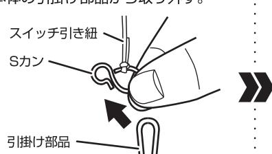
①本製品(交換用のスイッチ引き紐)についているSカンを本体の引掛け部品に取付けて、
