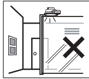
障害物が感知エリアをさえる場所 (透明なガラスやプラスチックも含む)
