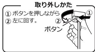
取り付け後、ボタンを押さずに左に回して、外れないことを確認する。
