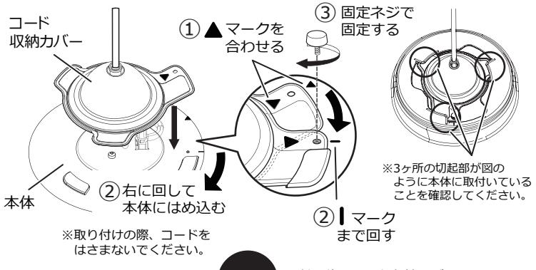
**確認** 取付け後、コード収納カバーを左に回して、外れないことを確認する。
