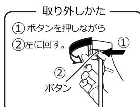
取付け後、ボタンを押さずに左に回して外れないことを確認する。
