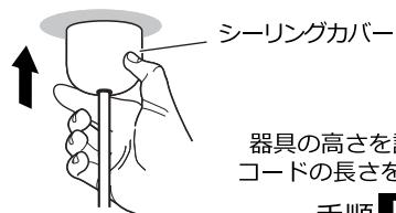
器具の高さを調節する場合は、コードの長さを調節してください
